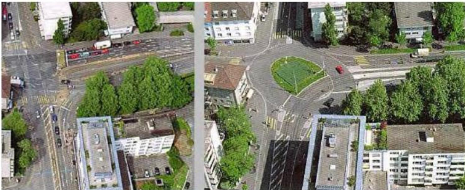
**Exemple de réaménagement d'une intersection en carrefour giratoire, avant et après modifications**
